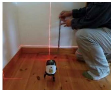
「床の傾きを計測する」調査機器
