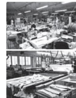
上/ミシンの音が響く縫製工程 下/CADで作成したパターンを基に自動裁断
