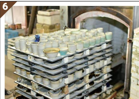
6 釉薬をかけ終わると、いよいよ「本焼き」です。窯には、登り窯、ガス窯、電気窯などの種類がありますが、小久慈焼では現在はガス窯を主に使用。窯の中には、湯呑みだと約300~400個の器が入ります。1時間で約100℃ずつ温度を上げ、1,230~1,250℃の温度で焼き上げます。火入れから17~18時間後に火を止め、1日かけて冷ましてから窯出し。最後に、研磨や艶出しなどの仕上げ作業を行い完成です。土練りから完成までは約2カ月。現在は、1カ月に2回程度本焼きを行い、商品を出荷しています。
