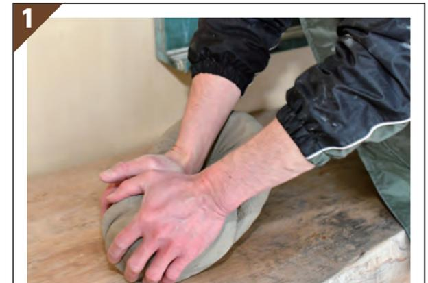
1 小久慈焼の陶土をつくる「土練り」。土の中の水分を均一にし、固さや質をそろえ、形が崩れないようにする「荒揉み」が第1工程。土の中の空気を抜き、粘り気を上げる「菊揉み」が第2工程です。土の中に空気が残っていると、焼くときに窯の中で爆発する場合がありますので、念入りに作業します。現代は機械を使って土練りをしますが、仕上げは職人が手で行います。小久慈焼は、夏井町半崎で採れる粘土を乾燥させ、細かく砕き、水を加え混ぜ、良い部分を抽出し脱水、練ったものを陶土としています。
