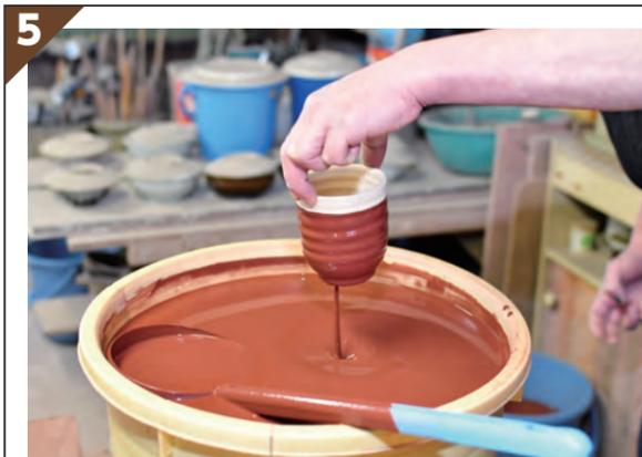
5 素焼きした焼き物に、釉薬をかける「施釉」。これにより、表面がガラス層の薄い層に覆われ、汚れが付きにくく丈夫になるだけでなく、水漏れ防止、装飾効果も高まります。施釉には、器を釉薬の中に入れて引き上げる「浸しかけ」。柄杓で注ぎかける「注ぎかけ」。スプレーガンなどで吹き付ける「吹きかけ」。筆やブラシで塗る「塗りかけ」の4つの方法があります。浸す時間によって色の濃さが変わり、作品の仕上がりが異なってくるので、どの方法も細やかな神経を使う仕事です。
