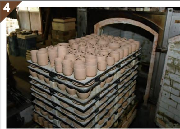
4 成形した粘土を約1カ月間乾燥させた場合でも水分は20%ほど残っています。そこで釉薬で表面を覆う前に、水分量が数%になるまで「素焼き」をします。780℃から800℃の温度で、約10時間焼き、丸一日かけて冷やす。これは、水分を蒸発させ吸水性を増し、釉薬を施しやすくすることだけでなく、不純物を燃やし焼き色を安定させること、陶土を焼き固め丈夫にする効果もあります。素焼きでも素地は収縮するので、本焼き時の収縮を減少させ、ひび割れや破損などのトラブルの防止にもつながります。
