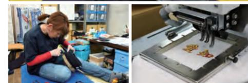
上/完成した剣道防具（面・胴） 左下/細かな作業は基本的に手作業で縫製します 右下/武道具などの刺しゅうを、自動で行う専用の機械
